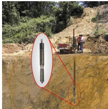
Obr. 1 Ukážka zatlačania meracieho hrotu statickej penetračnej skúšky [2].
