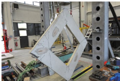
Obr. 4 Provádění experimentu stěny.
