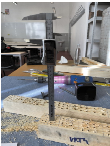
Obr. 3 Měření hloubky vrtů posuvným měřítkem.
