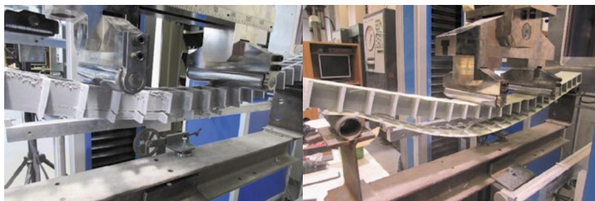
Obr. 9 Vzorky skúšané na 4-bodový ohyb.
