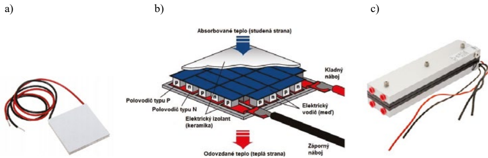
Obr. 6 Peltierov článok na účely chladenia [10];
