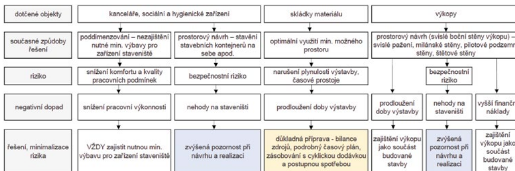
Obr. 2 Analýza negativních vlivů při redukcí redukcí půdorysné plochy zařízení stavenišť ve ztížených podmínkách výstavby.
