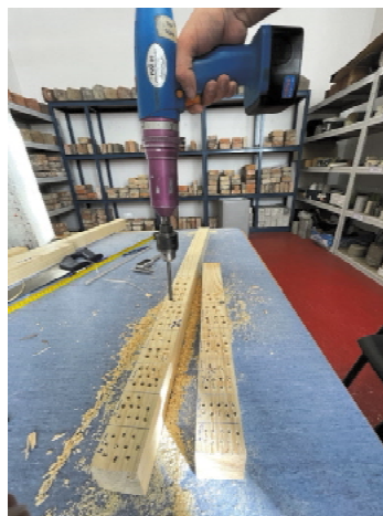
Obr. 3 Vrtý provedené elektrickou Kučerovou vrtačkou.
