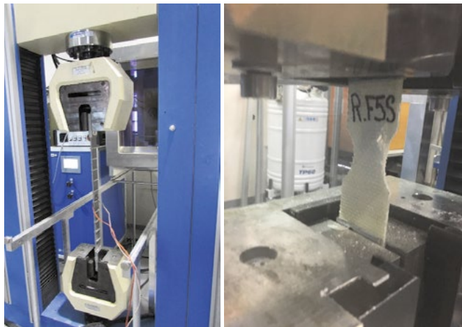
Obr. 5 Naľavo - ťahová skúška 1 rebra roštu; napravo - ťahová skúška laminátu.
