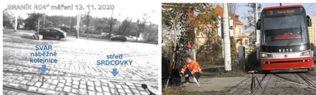
Obr. 2 Zorné pole akustické kamery se zvýrazněním zájmových bodů a prováděné měření dne 13. 11. 2020.
