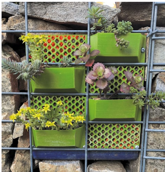
Obr. 5 Osázený fasádní panel při testování ve vegetačním období.
