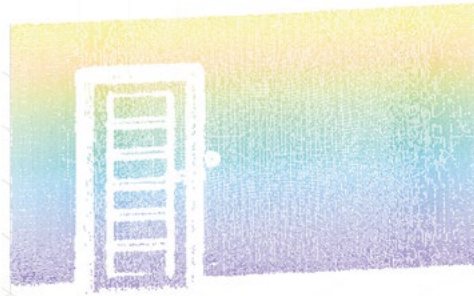
Obr. 3 Segmentované body po filtrácii na základe normál.
