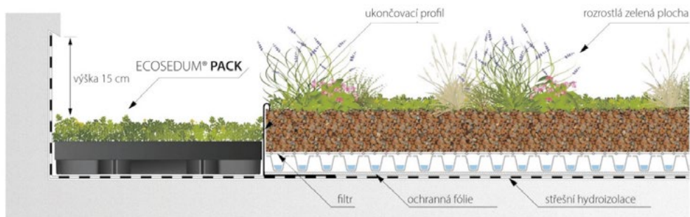
Obr. 2 Schématický řez předpřestovaným zásobníkem ECOSEDUM®PACK.
