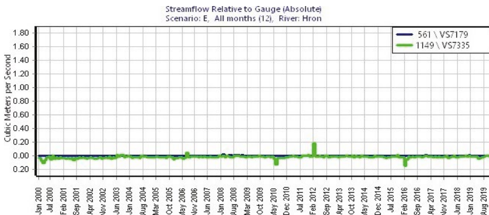
Obr. 5 Porovnanie simulovaného a pozorovaného prietoku na rieke Hron vo vodomerných staniách 7179 – Zvolen (rkm 157,7) a 7335 – Kamenín (rkm 10,9) pri úprave vlastností prvkov VHB.
