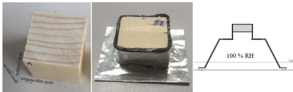
Obr. 1 Způsob rozdělení vzorků podle orientace (vlevo), způsob přípravení vzorků pro měření navlhavosti (uprostřed) a schéma způsobu měření navlhavosti (vpravo).
