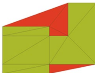
Obr. 7 Vytvořená síť pomocí Delaunayovy triangulace, kde zeleně jsou označeny relevantní prvky modelu a červeně prvky mimo model, které je potřeba vyselektovat.
