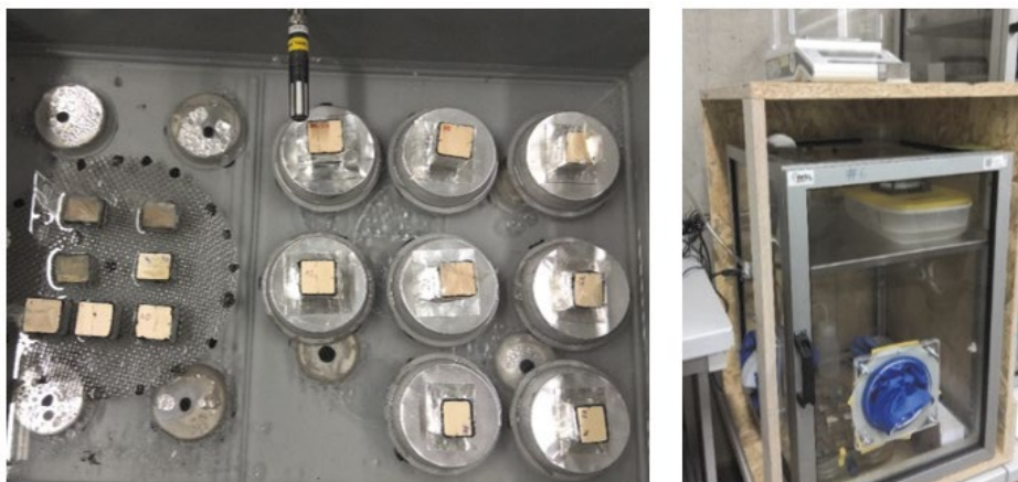
Obr. 2 Experimentální set pro měření nasákavosti a navlhavosti vysušených vzorků (vlevo) a nasákavosti nakondicionovaných vzorků ve speciálním exikátoru (vpravo).
