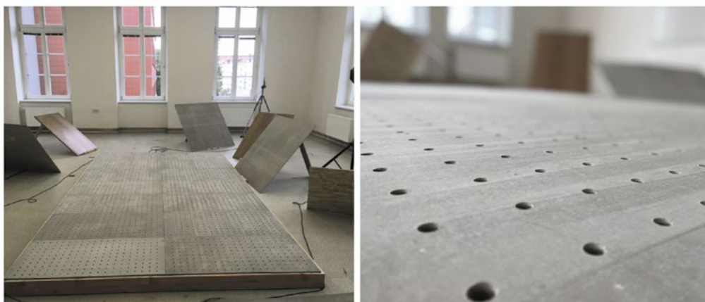
Obr. 3 Dozvuková místnost při experimentálním měření činitele zvukové pohltivosti, detail zkušební vzorku
