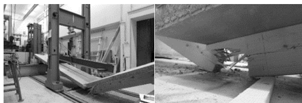
Obr. 1. Porušená vzorka (vľavo) a detail porušenia (vpravo).
