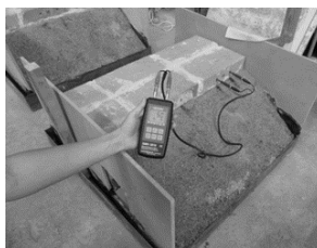
Obr. 1. Laboratorní model – cihelný pilíř s provětrávanou vzduchovou dutinou, měření vlhkosti
