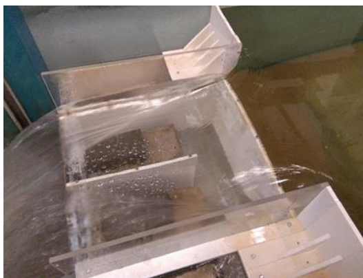
Obr. 1. Přeliv se širokou korunou s bočním zúžením s výškou přelivu P = 0,4 m s šířkou b = 0,5 m
